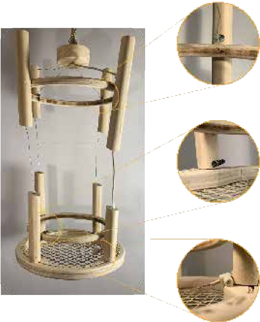
Modello in scala 1:2. In ordine a partire dall'alto sulla destra dettaglio: • della vite di giunzione tra l'anello superiore e le gambe superiori; • della vite di giunzione tra l'anello inferiore e le gambe inferiori; • fermacavo.
